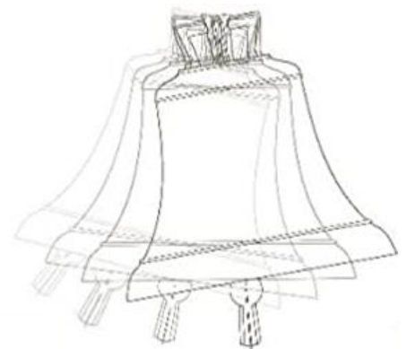
Abb. 3: Bewegung einer Glocke beim schwingenden Läuten. 3
